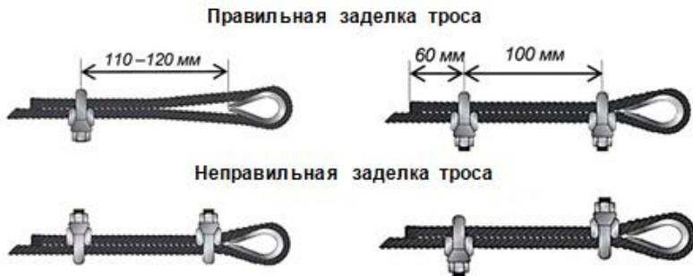
Рисунок 5. Заделка троса
