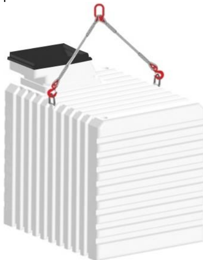
Рисунок 4. Крепление стропой СТП-1
